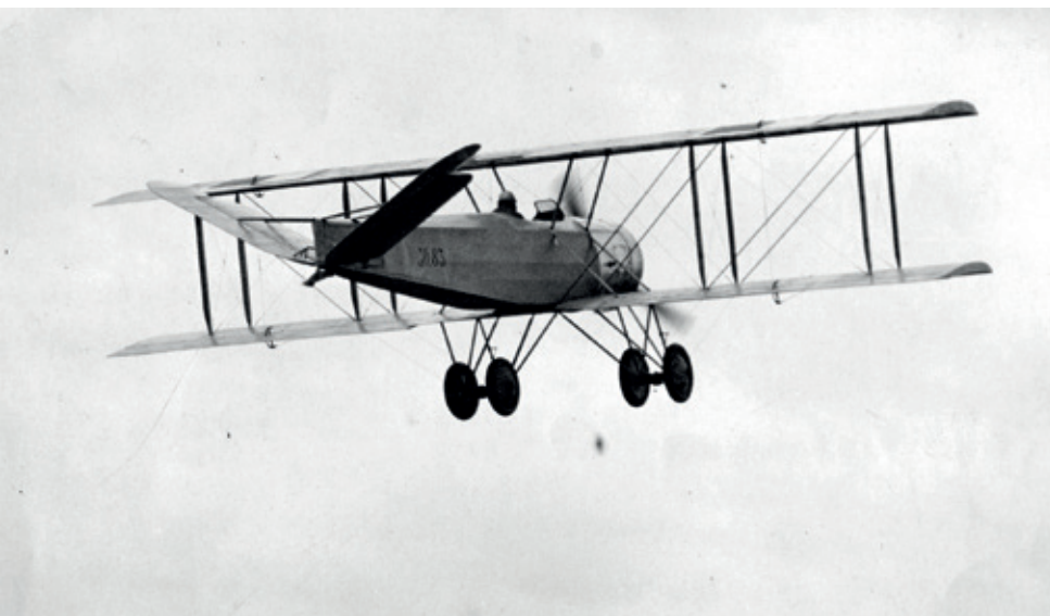
Samolot Hanriot H.28 ze zmodyfikowanym w wytwórni E. Plage i T. Laśkiewicz usterzeniem typu motylkowego, zaprojektowanym przez Jerzego Rudlickiego, startujący z lotniska Mokotowskiego w Warszawie. Fot. Narodowe Archiwum Cyfrowe
