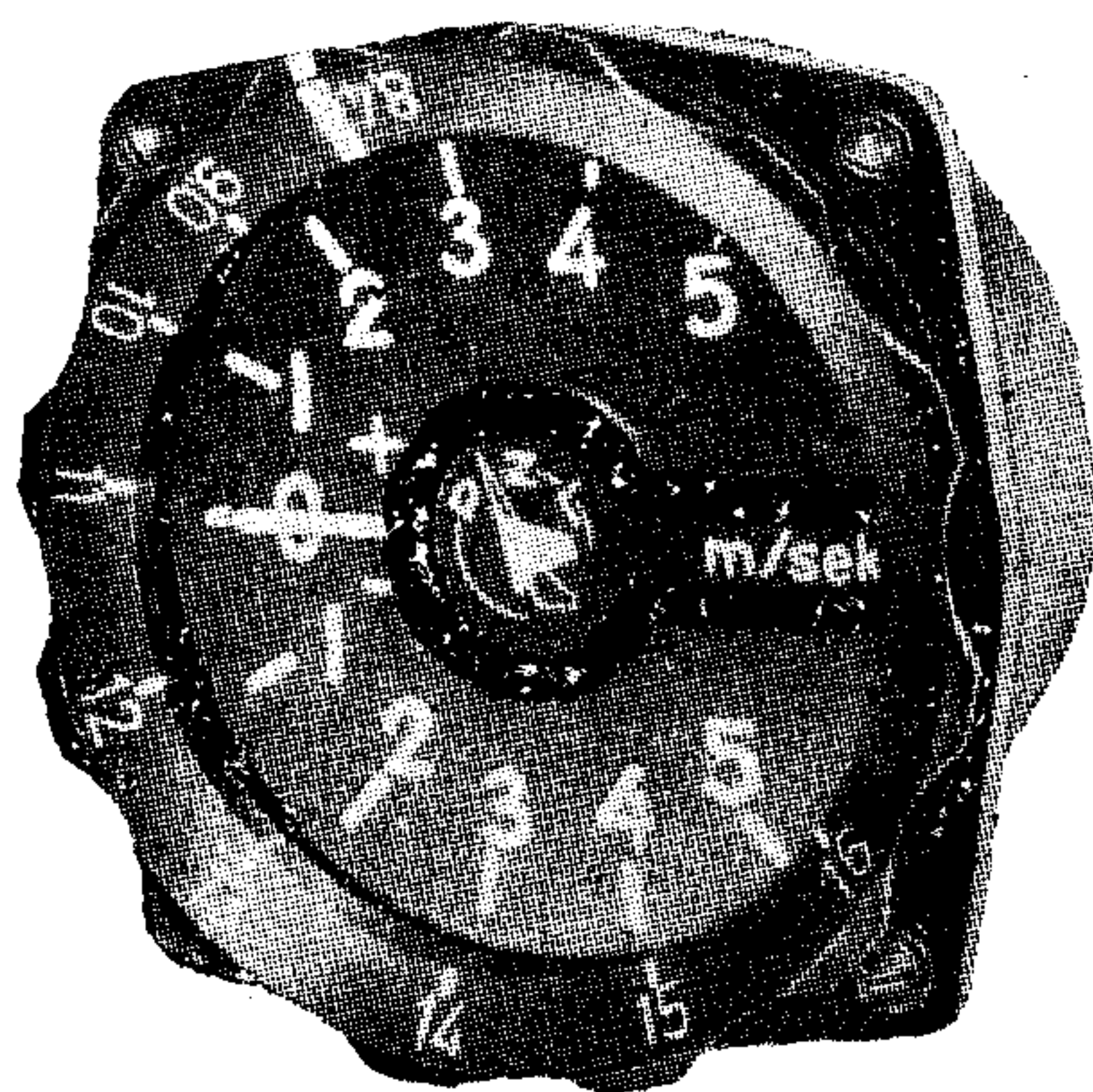
Rys. 21. Wariometr skrzydełkowy użyty jako WEC z obrotowym pierścieniem kalkulatoryjnym
