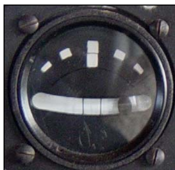
Zakrętomierz. Zasada działania [1]. Zakrętomierz EZS [2]
