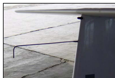
Rurka energii całkowitej usytuowana na stateczniku pionowym
