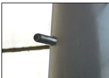
Dajnik ciśnienia całkowitego na stateczniku pionowym
