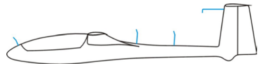
Miejsca montażu dajników energii całkowitej
