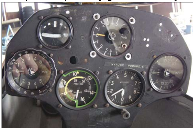
Tablica przyrządów szybowca Jantar std
