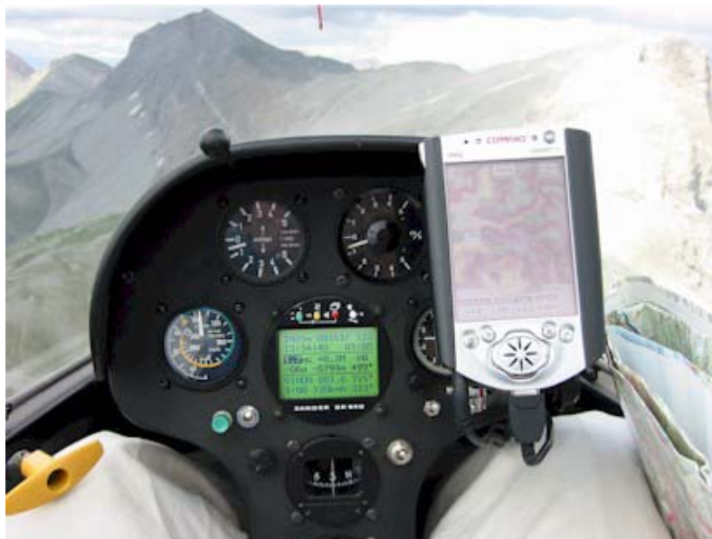
Tablica przyrządów z wariometrami elektrycznymi, kalkulatorem pokładowym i komputerem kieszonkowym Pocket PC [14]
